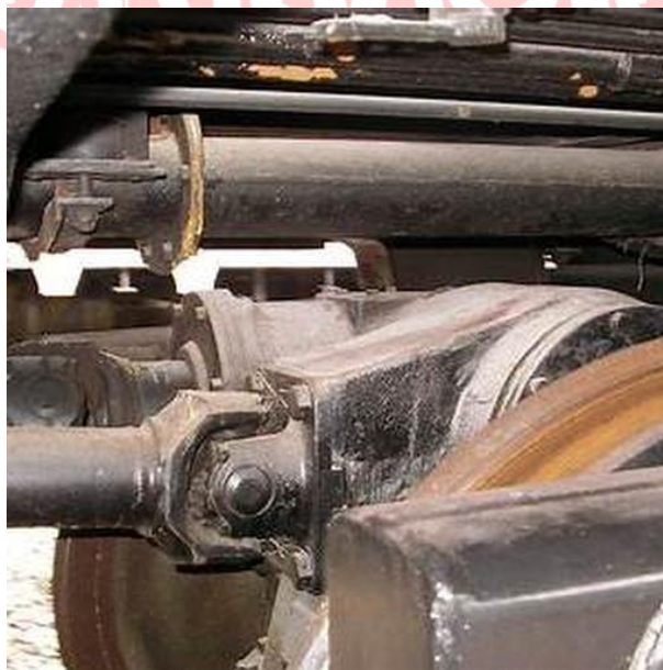
Imagen árbol de transmisión / eje en un vehículo. Refuerza la idea de que golpes, vibraciones o esfuerzos bruscos afectan al conjunto.
